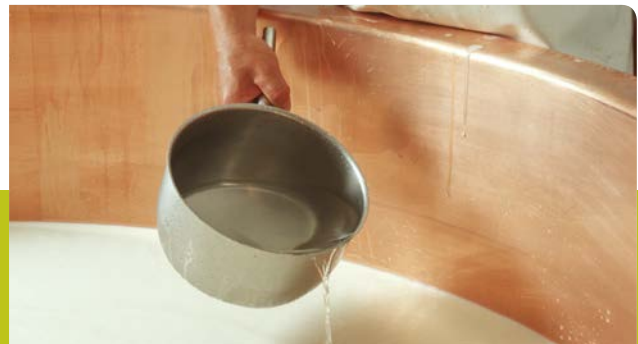
Abbildung 8: Zugabe der natürlichen Labflüssigkeit zur Gerinnung der Milch (Quelle: oekolandbau.de / ©BLE / Foto: Thomas Stephan)
